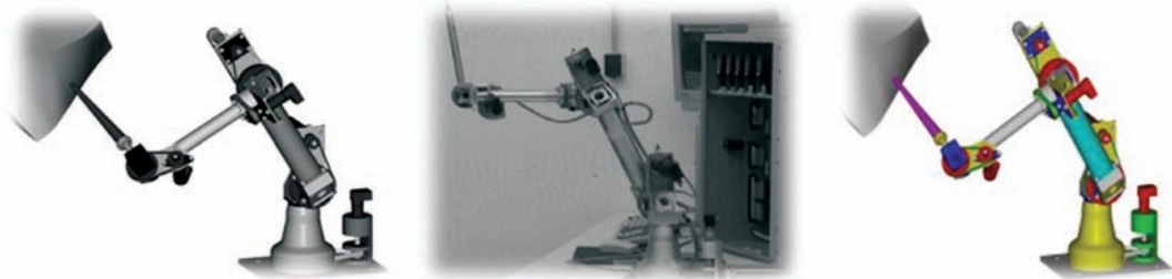
Ρομποτικός βραχίονας 5 DOF για οδήγηση δέσμης laser
