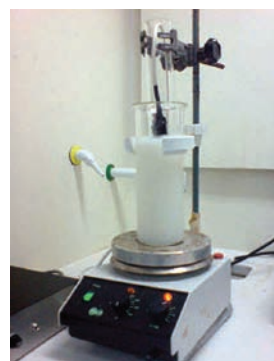
Εικόνα 5. Ο εργαστηριακός αντιδραστήρας φωτοκαταλυτικής απολύμανσης σε λειτουργία.
