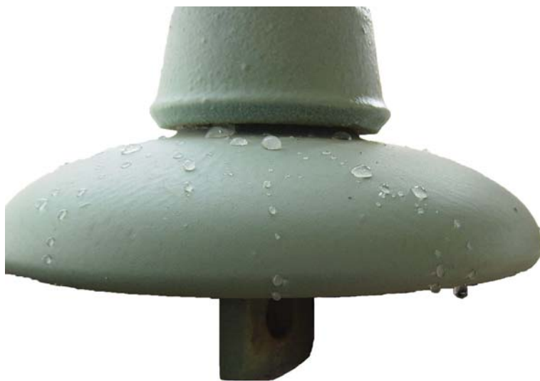
Σχήμα 5. Υδρόφοβη επιφανειακή συμπεριφορά σε μονωτήρα πορσελάνης με επικάλυψη από RTV SIR
