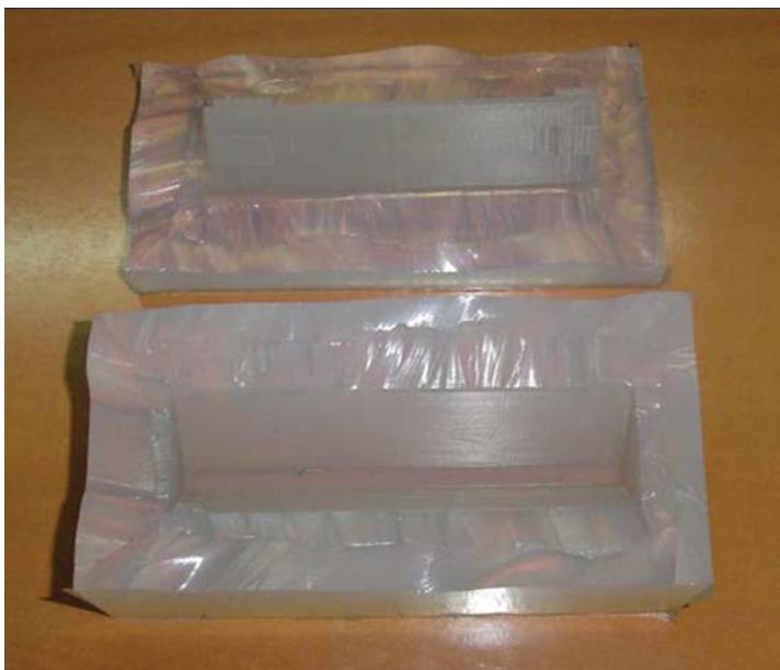
Εικόνα 8: Καλούπι χύτευσης από σιλικόνη κατασκευασμένο στη μονάδα, για την παραγωγή τεμαχίων από πλαστικό.
